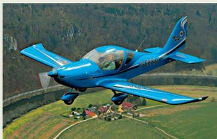
**EVEKTOR SPORTSTAR RTC** Von einem UL stammt der ebenfalls in Tschechien hergestellte Ganzmetall-Tiefdecker ab. In der LSA-Version bietet er bis zu 257 Kilo Zuladung. Auch hier dient ein Rotax 912 mit Vergaser und 100 PS als Antrieb. Der Hersteller gibt eine Reisegeschwindigkeit von 108 Knoten an. Ein Rettungssystem ist als Option erhältlich. Die Sportstar RTC wird für etwa 125 000 Euro angeboten.
