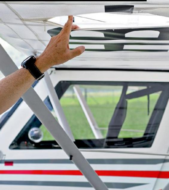
**Einfache Inspektion:** Reißverschlüsse in den Flächen ermöglichen die Kontrolle des Innenlebens
