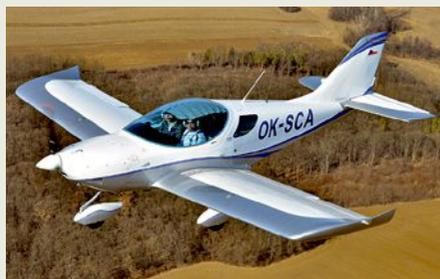
**CZECH SPORT AIRCRAFT PS-28** Der Metall-Tiefdecker aus Tschechien wird von einem Vergaser-Rotax 912 mit 100 PS angetrieben. Die im Reiseflug etwa 95 Knoten schnelle Maschine wird in Varianten mit Glascockpit oder »Uhrenladen« und optional mit einem Gesamttretungssystem angeboten. Je nach Ausstattung bietet sie bis zu 225 Kilo Zuladung. Ein Pilot Report findet sich in *fliegermagazin* #8.2012. Die PS-28 ist ab etwa 110 000 Euro erhältlich.
