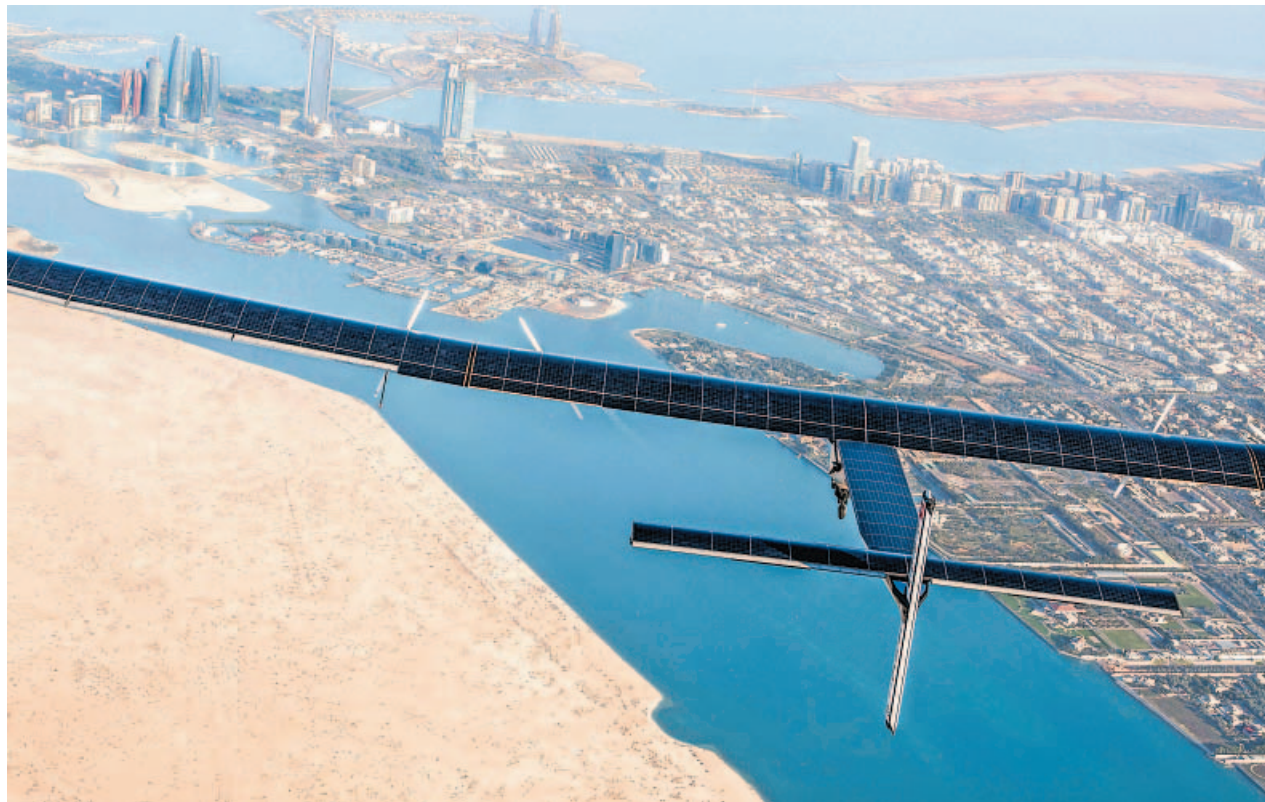
Mehr als 17 000 Solarzellen bedecken das Flugzeug „Solar Impulse 2“, das nur mit Sonnenenergie fliegt. Das Bild zeigt die Maschine bei einem Testflug über Abu Dhabi. Von dort ist sie im März zur Weltumrundung aufgebrochen. Foto: dpa
